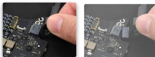
結束されたケーブル用コネクタには多くの細い電線が接続されており、電線がチューブで覆われていることもあります。このようなコネクタにはスパッジャーで押し下りピンセットで掴めるような場所がないこともあります。ケーブル自体を引っ張るのが接続を外すための唯一の方法かも知れません。
