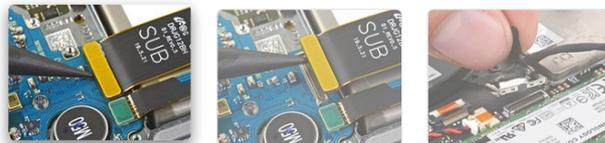
小さなプレスコネクタはリボンケーブルの端にあり、コネクタの上に通常長方形の金属や樹脂製の覆いが付いています。このようなコネクタはスマートフォンやノート型PCで非常に一般的に使われており、スクリーンやバッテリー、基板間の接続などの細いケーブルから中間程度の太さのケーブルの接続に広く使われています。
