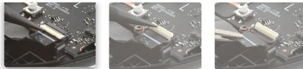
**Zero Insertion Force/ゼロ挿入力 (ZIF) コネクタ**はFFC (Flat Flex Cables) やFPC (Flexible Printed Circuit)などのようなデリケートなリボンケーブルを結合するために使われます。しかしながら、修理初心者にはトラブルをもたらすことがあります。
