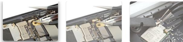
アンテナコネクタ、U.FLコネクタ、IPEXコネクタとも呼ばれるこのような同軸コネクタは、金属製の頭部が基板にある円形のソケットにカチッとハマるようになっています。このソケットはシャツについている金属製のスナップボタンのような形をしています。このコネクタにはさまざまなサイズがあり、Wi-Fiや携帯電話のアンテナケーブルの接続によく使われます。
