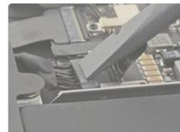
大型スライド式コネクタはより小さなスライド式コネクタと同じように機能しており、通常はソケットの側面から差し込まれています。一般的に、このようなコネクタには複数のケーブルが繋がっており、ノート型PCのバッテリーとの接続によく使われています。
