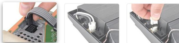
電源ケーブル、もしくは電源供給ケーブルコネクタは、通常複数のケーブルが固定用のつまみを備えた大きめのプラグに接続されています。このようなコネクタは、ゲーム機やデスクトップPCのような大きめの電子機器でよく見かけます。
