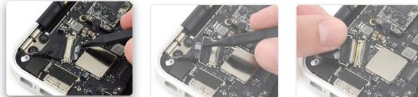
ディスプレイケーブル（ノート型PCではeDPケーブルとも呼ばれます）とカメラケーブルコネクタには、ソケットの裏側を通る金属製バックルがケーブルを固定するために付いていることがあります。このようなコネクタは大抵幅が広く、バックルにはテープが貼られていることがあります。
