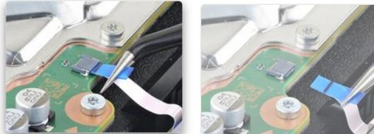
ZIFコネクタに似ているけれどロック用フラップがないソケットにリボンケーブルが接続されているのを見かけるかも知れません。通常、このケーブルはZIFコネクタに使用される通常のケーブルよりも丈夫で、先端は硬いプラスチックフィルムで補強されています。これらのコネクタは、プリンターやプロジェクター、ゲームコンソールなどの、大型の製品によく見られます。
