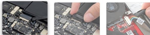
コネクタの中には、ソケットの上側を覆うように平らなプラスチック製の覆いが付いているものがあります。このようなコネクタには複数のケーブルが接続されていることもあります。フラットトップコネクタは通常広い側に取り付けられており、ノートパソコンや大型のゲーム機器でバッテリーと接続するためによく使われています。
