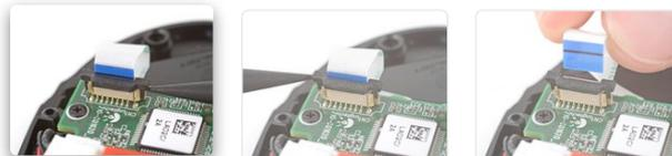
リボンケーブル用コネクタの中には、リボンケーブルを囲むように樹脂製の固定用のつまみが付いているものがあります。このようなコネクタは大型のゲームコンソールやマウスでよく使われています。
