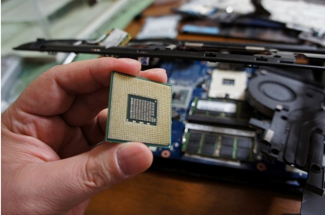
CPU を乗せて、ネジを締めます
