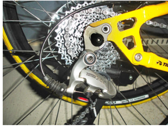
ママチャリの内装3段変速機と9段外装変速機カセット式フリーハブ（マウンテンバイク）
