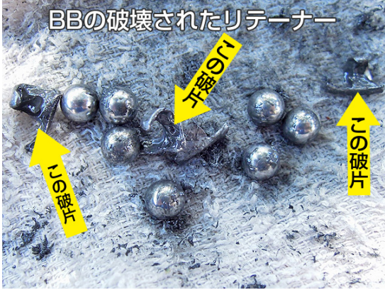
リアハブ内のリテーナーが破壊して回転するたびに異音発生!
