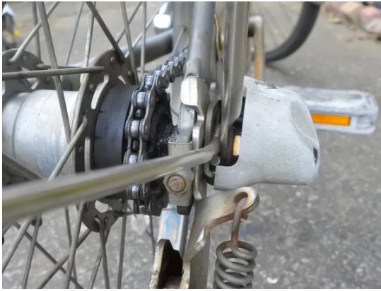
ママチャリの内装3段変速機と9段外装変速機カセット式フリーハブ（マウンテンバイク）
