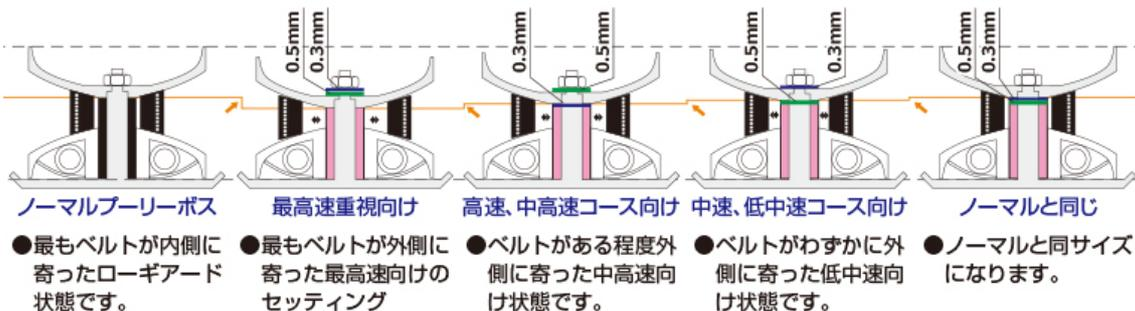
プーリーのセンターに位置するプーリーボスの長さを変える事によって、ドライブベルトをよりプーリーの外側に移動させる事が可能になり、最高速をアップさせます。また、2枚付属しているシムの取付位置
