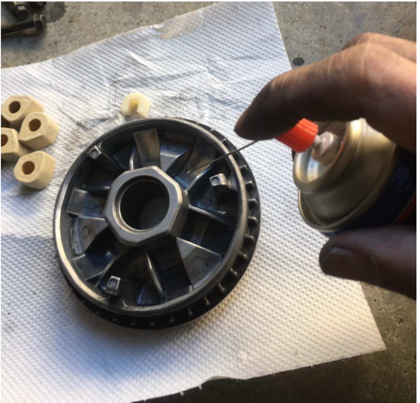
プーリーのローラーガイドにもシュッといきます
