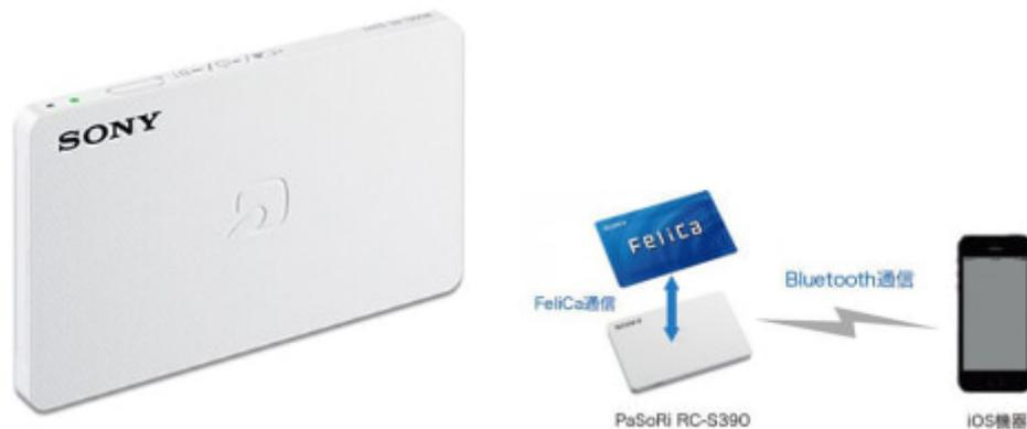
RC-S390はBluetooth接続の電子マネーカードリーダー/ライターで、iOSに対応している。iPhoneと無線接続して電子マネー残高などを表示できるという機器。これを使えば、たとえば「**パソリユーティリティアプリ**」で電子マネー残高や使用履歴などを表示できる。電子マネーはSuica、楽天Edy、nanaco、WAONに対応。
