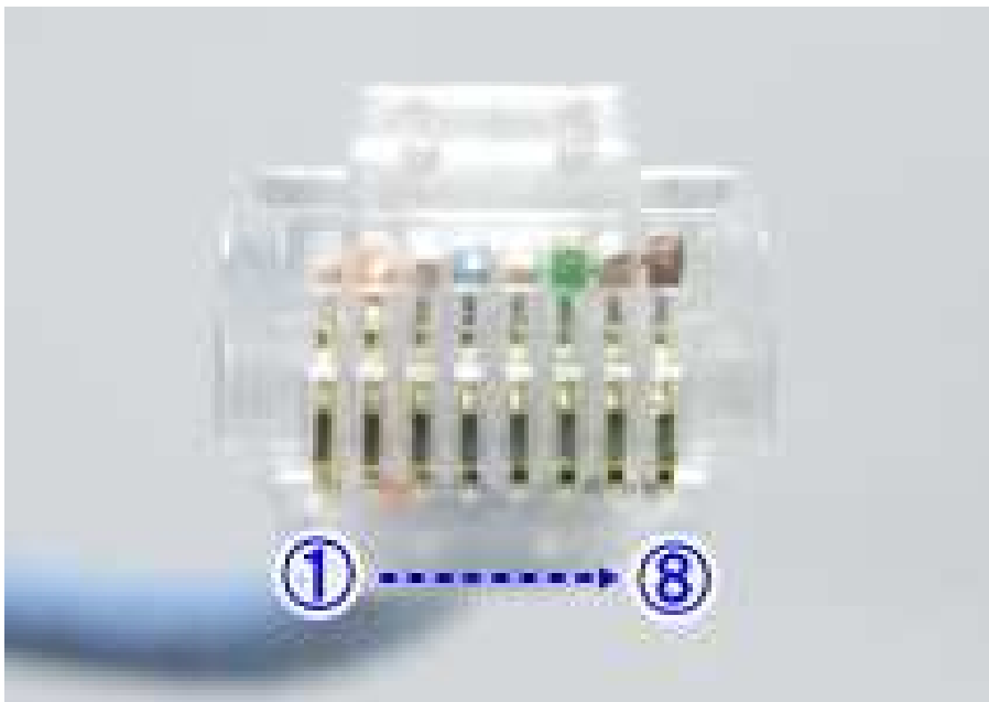
T568Bのストレート結線 (100BASE-TX、1000BASE-T、1000BASE-TX)
