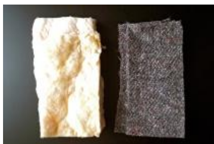
取り出した吸音材と同量になるように、試聴用の吸音材をカット。
