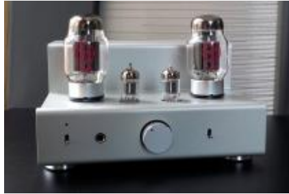
試聴に使ったエレキット「TU-8200」。コンデンサーと抵抗を交換済み。真空管も写真とは違うJJ「6L6GC」を使用。
