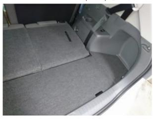
補機バッテリーはトランクルーム内の向かって右側の右リヤタイヤ後ろに装着されていますので、先ず トランクフロアカバーと収納ケースを取り外しておきます。
