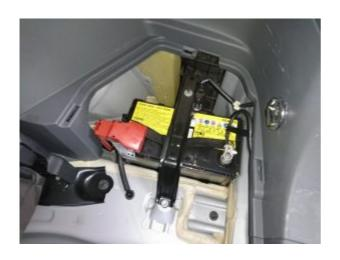
プラス側の短側面に排気ホースがある以外は、普通の国産車と同様の手順でバッテリーの交換作業が可能です。バッテリー本体上面の固定ステーを外し、マイナス、プラスの順にターミナル部を緩めていきます。工具も10mmのスパナが1本あれば事足りますので、車載工具でも作業出来るかと思います。
