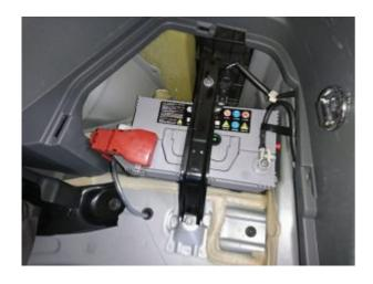
新バッテリーを元あったように車両に取り付けていきます。排気ホースは純正品(元のバッテリーのもの)とは形状が異なりますので製品に付属のものを使用しています。
