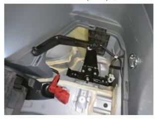
旧バッテリー、排気ホースを取り外したところです。バッテリー上面の固定ステーは、画像のように上 方向に避けておけばバッテリーの脱着は可能です。
