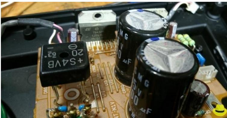
裏表を確認しながら、電気の入り口から辿っていきます。電源部分を目視します。「焦げたり破損したり」と目視の上では問題なさそうですね。電源部は傷んでなさそうです。一通り目視が終わってそれでも故障個所が発見できなければ実際に電気を流しながらチェックするつもりです。
