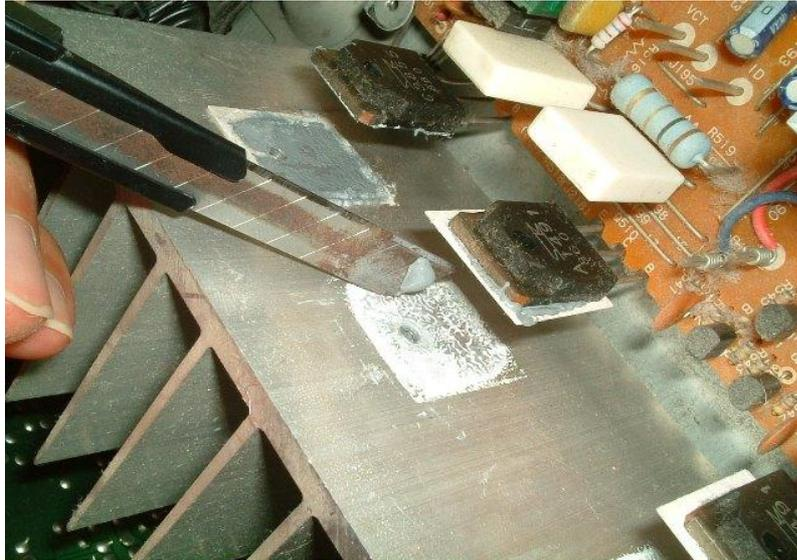
パワートランジスタ（黒いやつが強烈に発熱する）の放熱を助けるために巨大なヒート・シンク（アルミ製のギザギザ物体）を密着させますが、間にシリコングリスを入れて熱伝導を向上させます。
