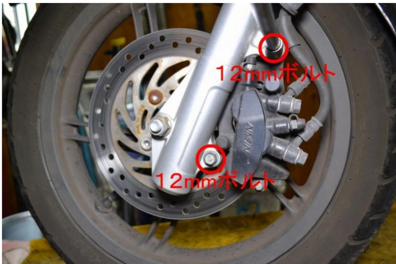
フロントブレーキキャリパーを固定している12mmのボルト2本を外します。
