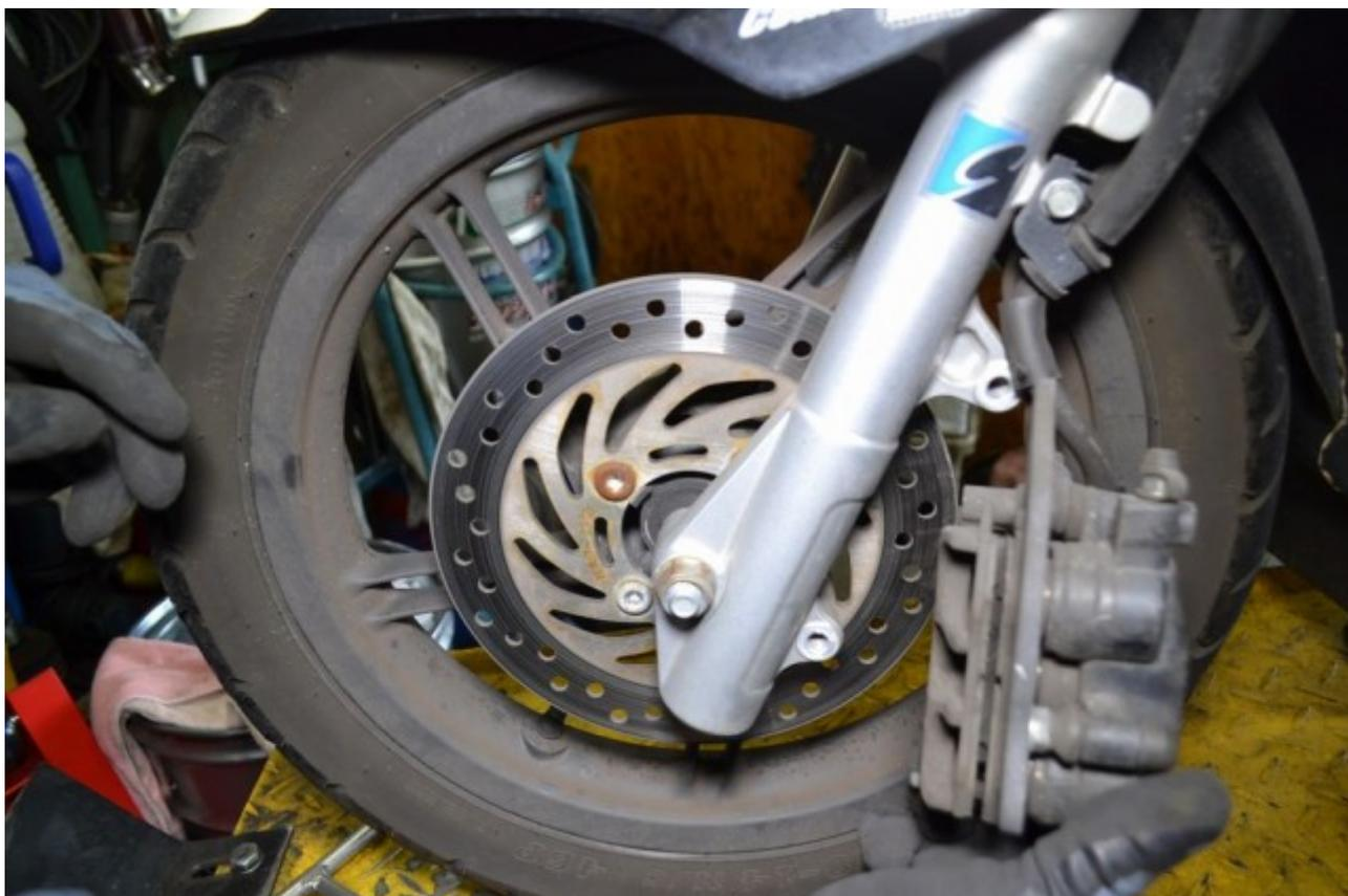
フロントブレーキキャリパーが外れにくい時はプラスチックハンマー等で軽く叩きます。パッドの残量を確認し、ブレーキクリーナーでダストを洗浄すると良いでしょう。
