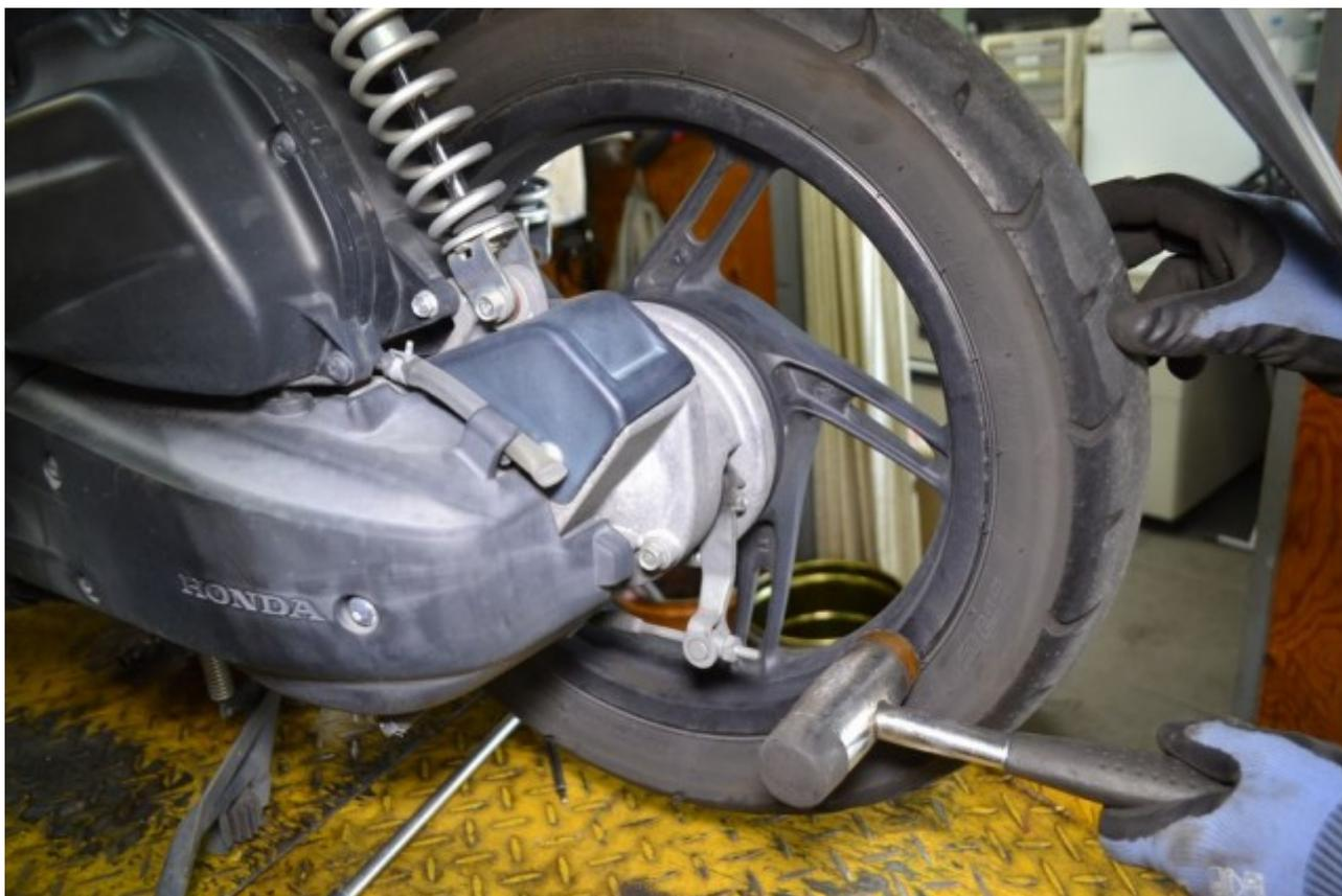
ホイールを回しながら根気よく叩きます。ブレーキを締め過ぎて外れない事もありますので、リアブレーキ調整ネジを緩めると良いでしょう。
