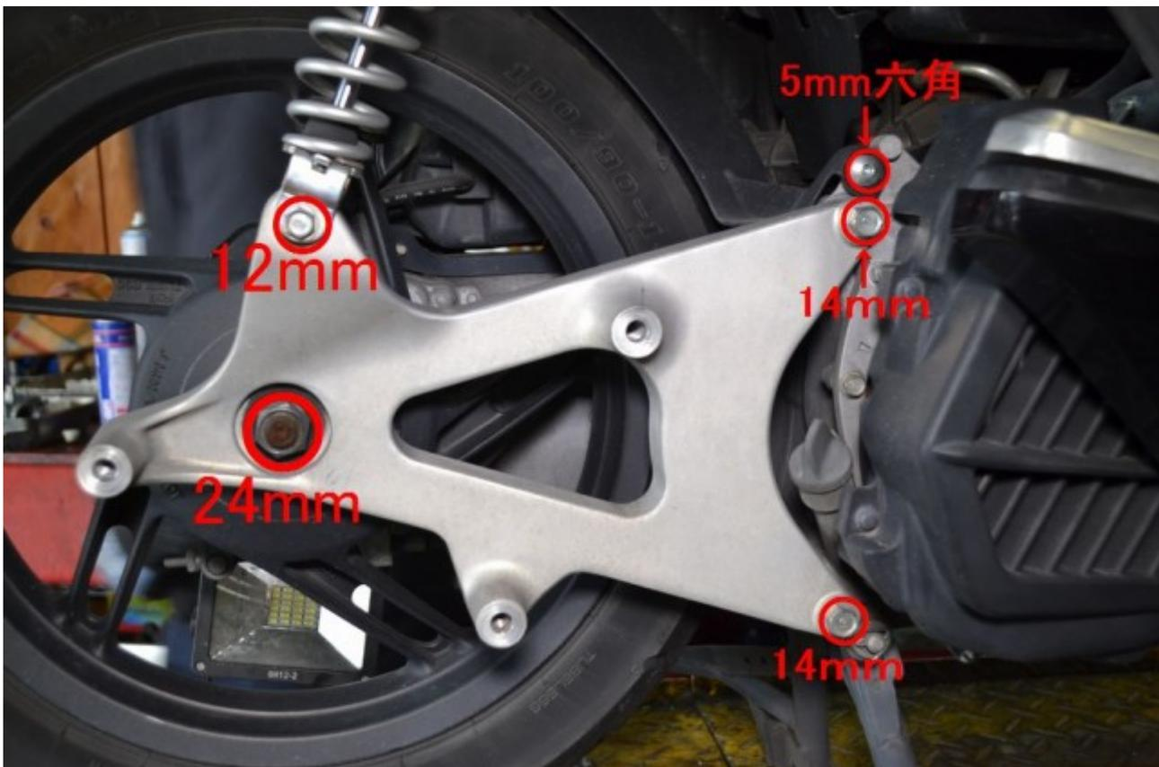
センターの24mmナットを緩めます。インパクトレンチがあれば簡単ですが、無ければソケットレンチを装着し、ハンマー等で叩けば外れます。リアショックの12mmのボルトとスイングアームを固定している14mmボルト2本を外します。
