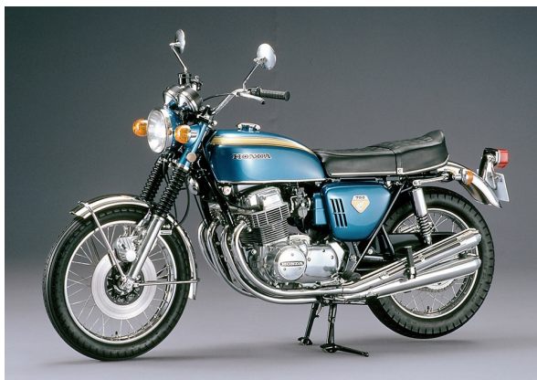
バイクの量産車として初めてディスクブレーキを搭載した1969年のDREAM CB750FOUR
