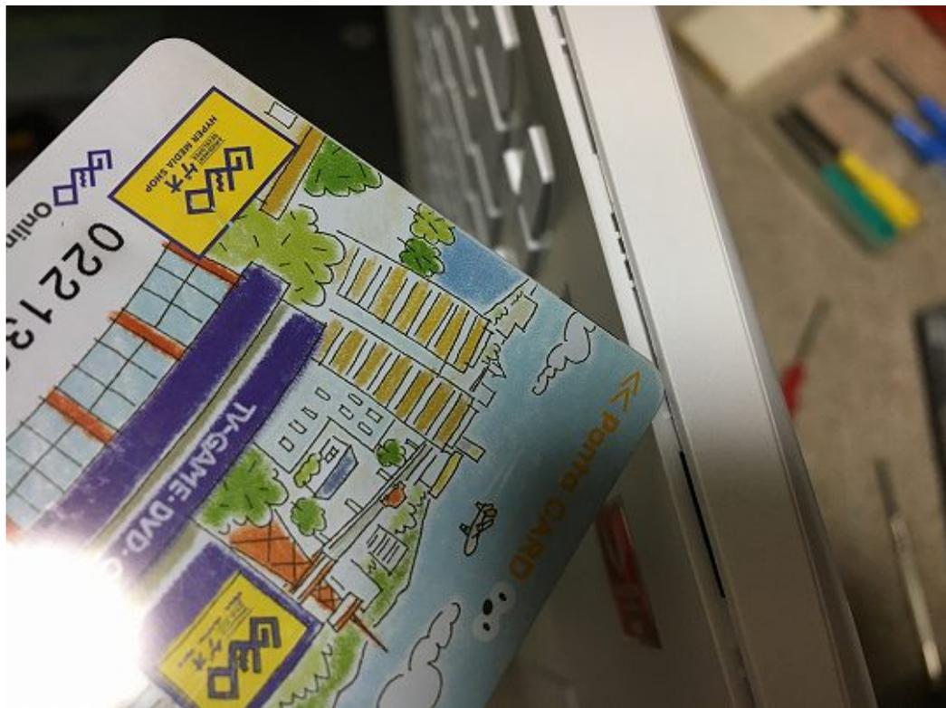
写真ではカードを取っていますが、差し込んだら**テコの原理**でカードを内側に押ししてください。
