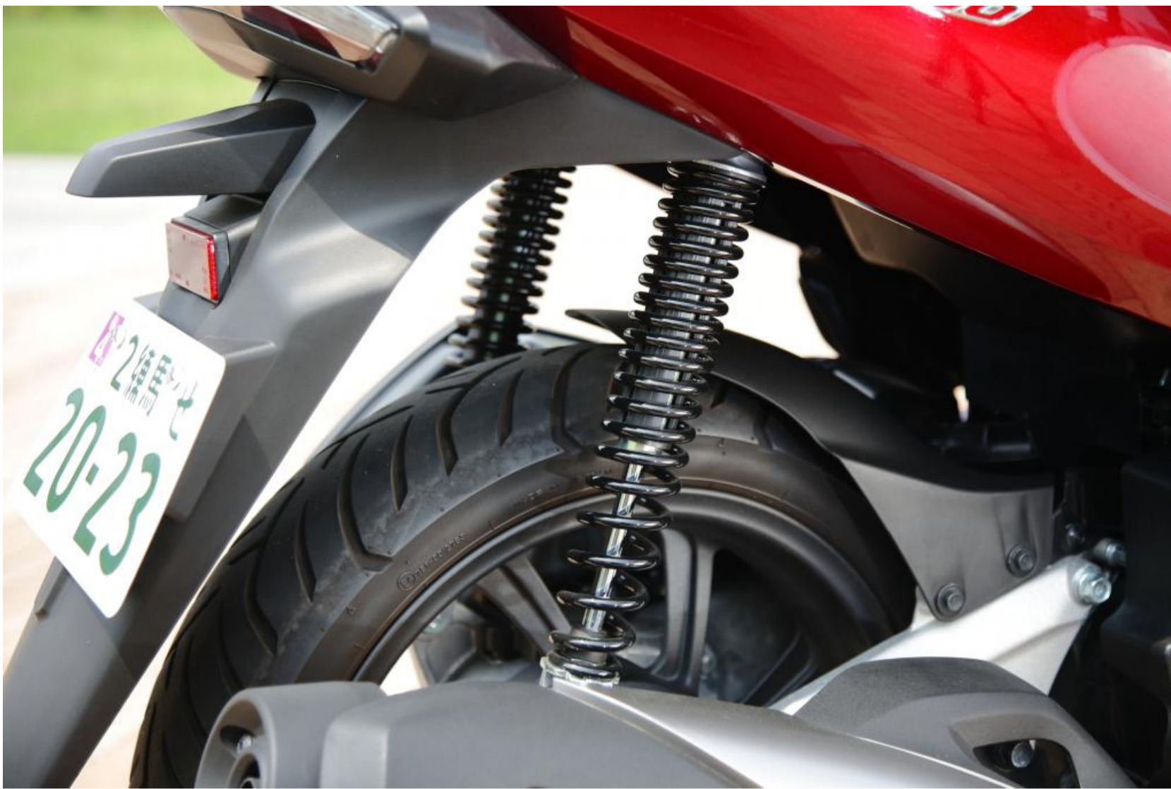
フルモデルチェンジでリヤサスペンションのストローク量を増加。また、フレームをダブルクレードル式に変更し、車体剛性を高めている。
