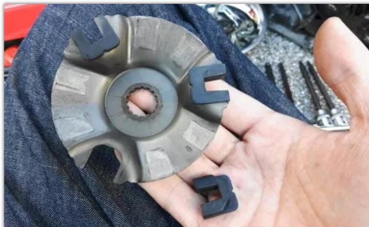
スライダも当然消耗品です。プーリーは走行中の加速・減速・変速時に左右に動きますのでスライダは摩耗します。特に加速時には大きな負担がかかっています。
