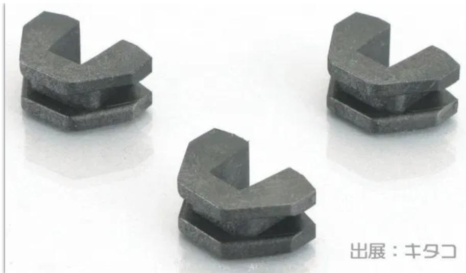
スライドピース(以下:スライダ)は、ウェイトローラーを押さえつけているランププレートに使われている樹脂性の部品です。エンジンの回転運動はこのランププレートに伝えられ、プーリーにはランププレートを伝って回転運動が伝わります。鉄製のランププレートが、アルミ製プーリーにダメージを与えない様に保護するクッションの役割を担っています(鉄の方が硬いため)
